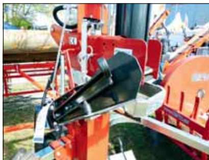
Firma Eifo oferuje teraz do swojego rębarka stojącego o sile łupania 16 t kombinowaną dźwignię sterowania, która zastępuje oburęczną obsługę urządzenia.
