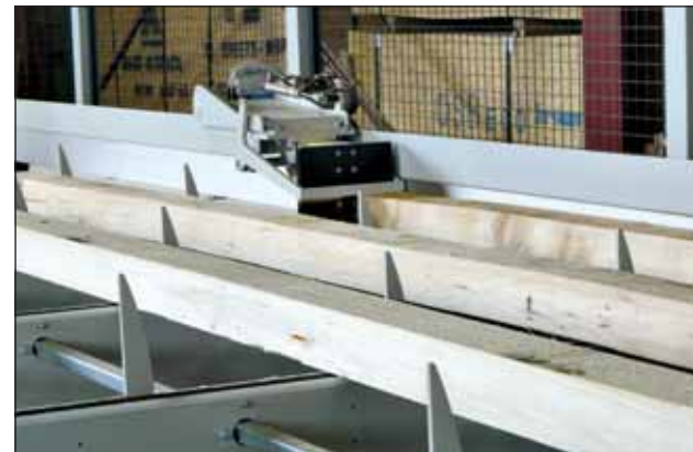
Poprzeczne ładowanie łańcuchowe z rzędami zapadek. Z tyłu zasuwu obrotowa z prędkością przemieszczania do 180 m/min.
