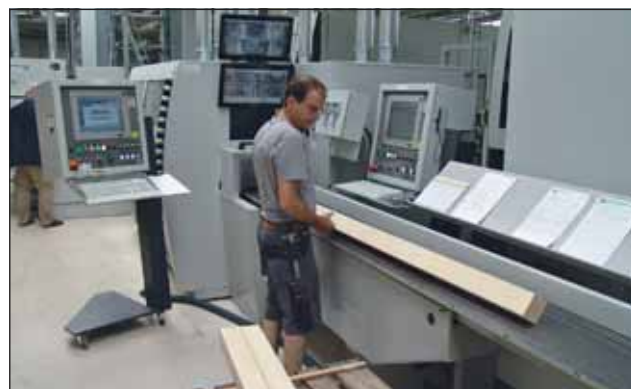
Początek produkcji: wlot przy strugarce czterostronnej „Powermat 1200“, poprzez jej stoły mogą być wprowadzane surowce graniaki o długości do 5 m.
