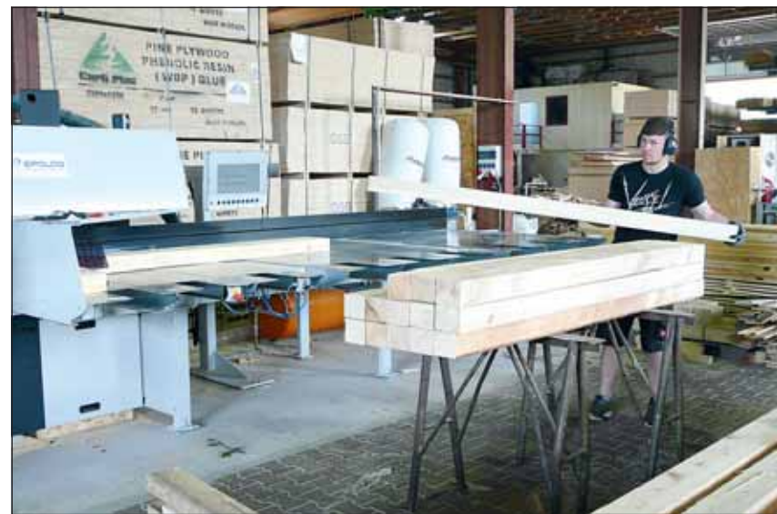
Poszczególne zlecenia mogą być prezentowane na ekranie wylotowym w różnych kolorach, co ułatwia przyporządkowywanie odcinanych elementów po stronie odbioru do różnych zleceń.
