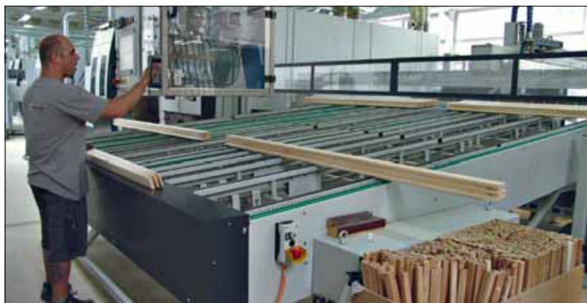
W miejscu wylotu, już po kontroli końcowej, urządzenie opuszcza poddane kompleksowej obróbce i gotowe do oklejania elementy.
