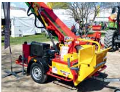
Mobilne, umieszczone na własnej naczepie i wyposażone w silnik benzynowy urządzenie „Xyloscie 700 M”, firmy Rabaud.
