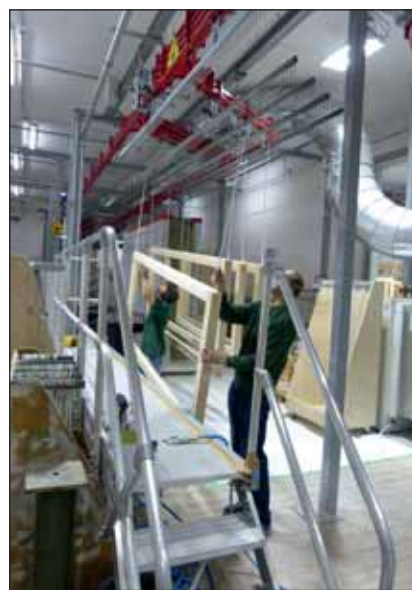
Stanowisko wiszące do uzbrajania trawers. Z reguły elementy pozostają przez cały proces nanoszenia powłok na trawersie.
