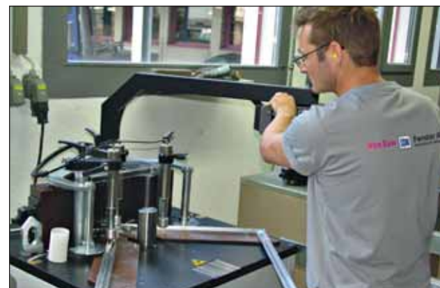
Profile aluminiowe do okien drewniano-aluminiowych docinane są, wykrawane w rogach i lakierowane metodą wypalania na miejscu, w zakładzie.
