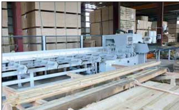
Ze względu na miejsce firma Epolog kupiła (rzadszą) lewostronną wersję urządzenia „Opticut”, tzn. taką, w przypadku której drewno doprowadzane jest do pilarki z lewej strony.
