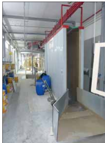
Wlot do drugiego kanału nanoszenia lakieru dyszlami, w którym – w razie potrzeby – może być nanoszona bezbarwna warstwa pośrednia
