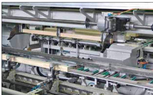
Automatyczna piła poprzeczna podwójna przerzyna surowiec w celu uzyskania gotowych wymiarów, następnie graniaki mocowane są na stołach z kleszczami mocującymi.
