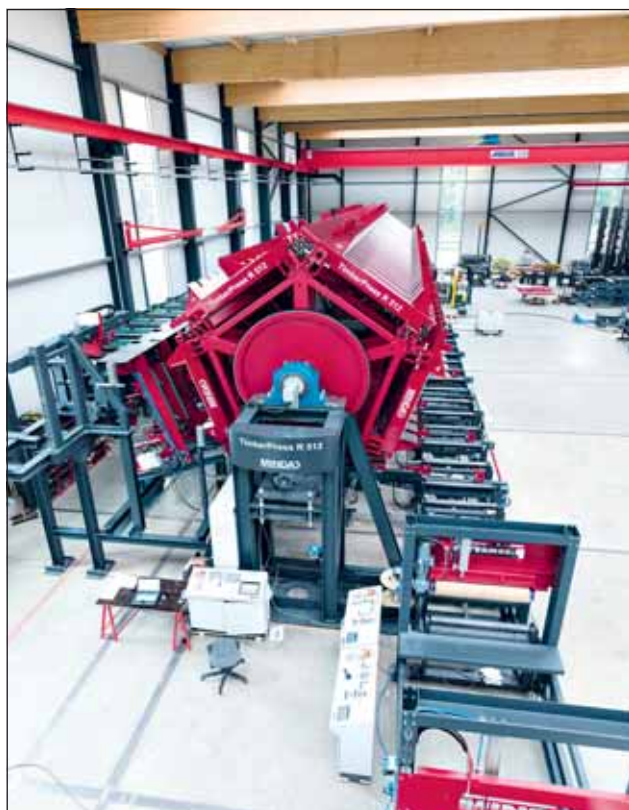
Prototyp urządzenia „Timber-Press 500” w otwartej w 2013 r. hali do produkcji drewna w firmie Minda. Po lewej stronie prasy wlot listewek i napelnianie, pod prasą i po stronie prawej wylot sprasowanego drewna klejonego.
