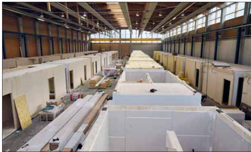
Niezależnie od warunków atmosferycznych realizowana produkcja seryjna modułów przestrzennych w firmie Kaufmann Bausysteme w Austrii. Zdjęcie: Kaufmann Bausysteme
