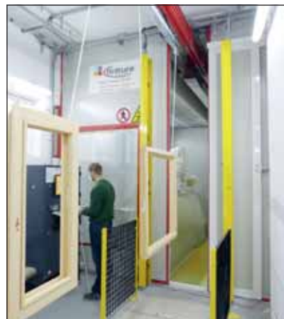
Dwa stojące naprzeciw siebie agregaty lakierują w krótkim czasie z przodu i z tyłu elementy okien i drzwi.
