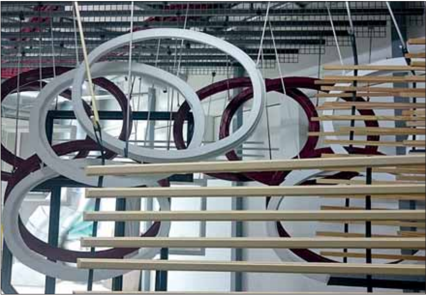
W kanale osuszania, za kabiną natryskową, elementy osuszane są poprzez osuszanie kondensacyjne na tyle, że mogą opuścić urządzenie ułożone w stosy.
