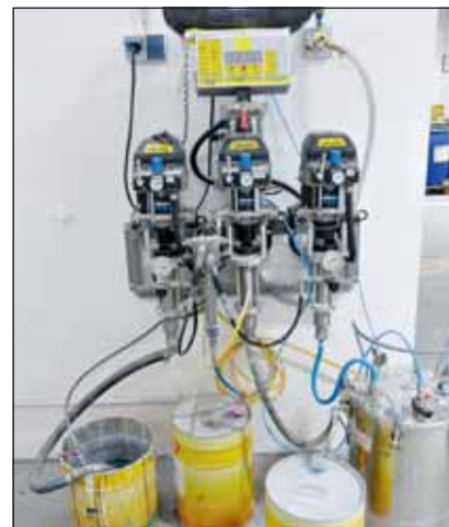
Dwa stojące naprzeciw siebie agregaty lakierują w krótkim czasie z przodu i z tyłu elementy okien i drzwi.
