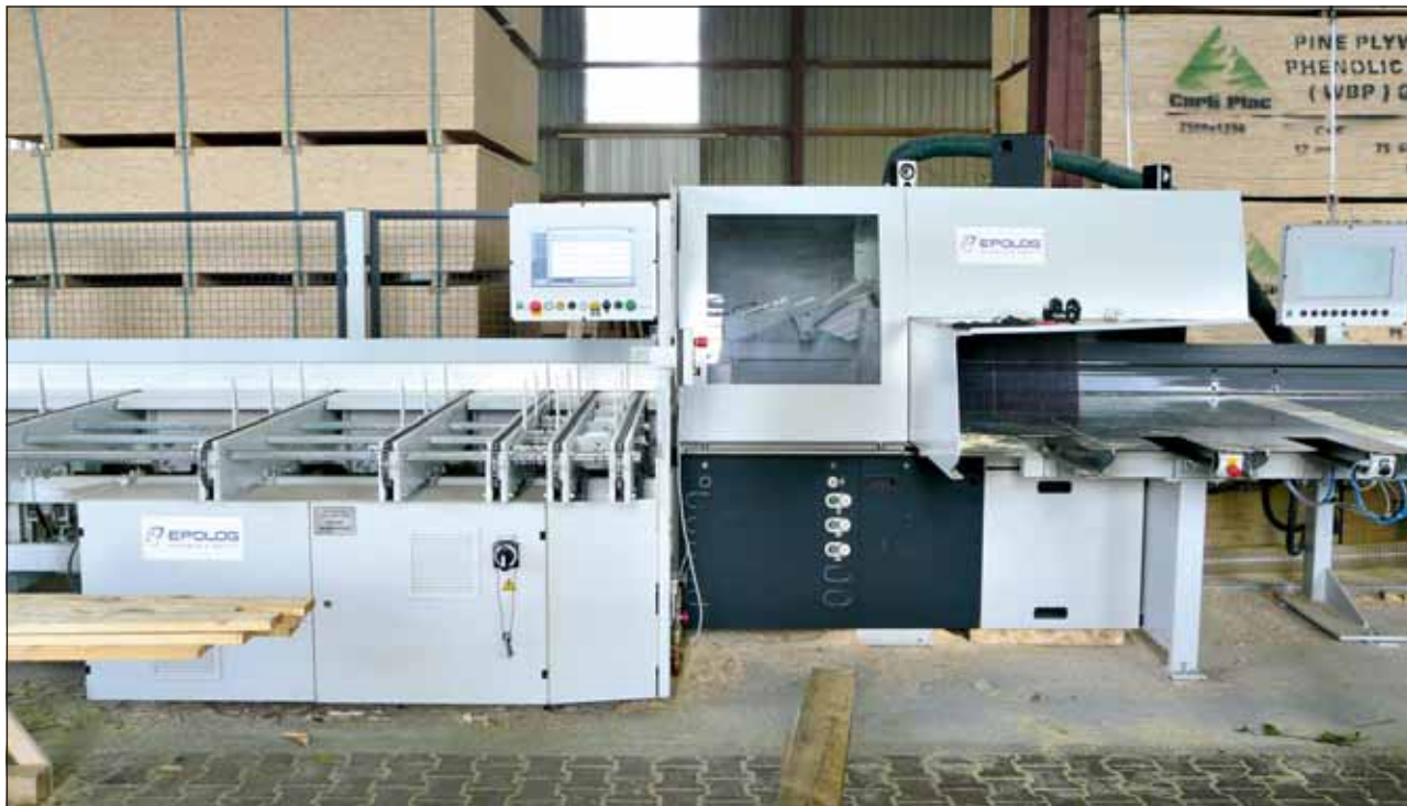
Urządzeniu do poprzecznego przecinania „Opticut” sterowane jest za pomocą przyrządu sterowniczego „Opti-Com Pro” (na zdjęciu po lewej stronie). Na środku (za szklaną szybą) znajduje się jednostka tartaczna z szybką pilarką dolnostolikową. Zdjęcia: L.Pirson
