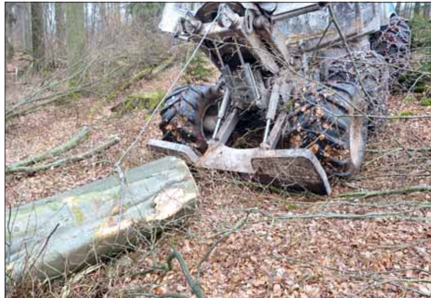
Przy obwiązywaniu linami bardzo pomocny jest blok linowy z opcją hydraulicznego przestawiania wysokości, szczególnie w miejscach na zboczach zaścienianych blokami tektonicznymi.
