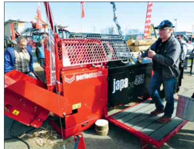
„Japa 435” z opatentowanym klinem rozszczepiającym. Zdjęcia: Ißleib
