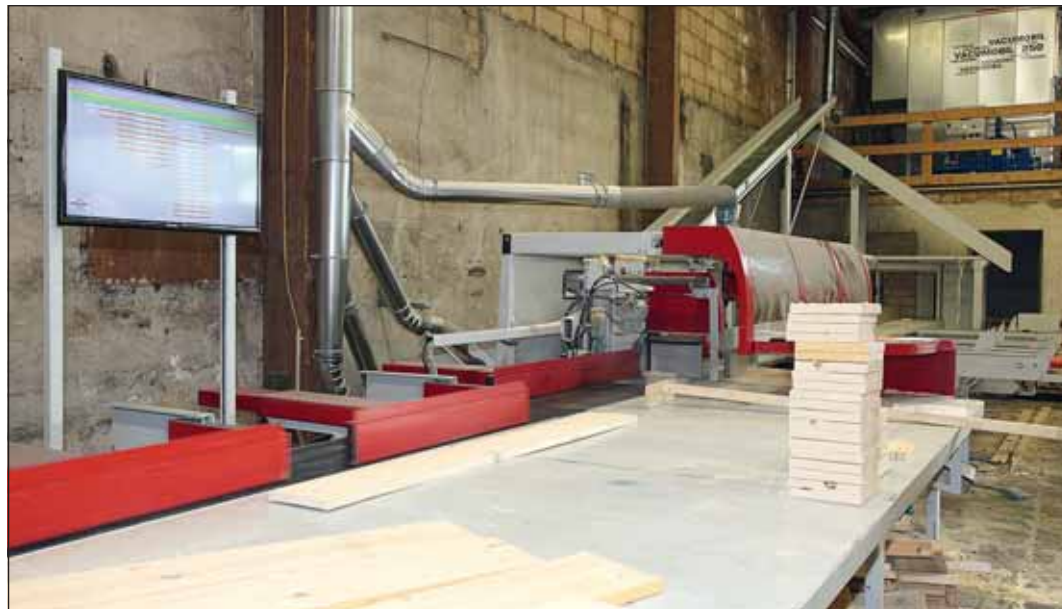
Prostsze śledzenie elementów obrabianych dzięki zastosowaniu ekranu (po stronie lewej) i opryskiwacza mgławicowego atramentowego.
