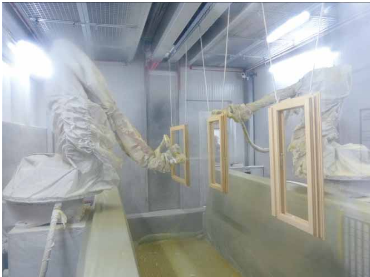
Dwa stojące naprzeciw siebie agregaty lakierują w krótkim czasie z przodu i z tyłu elementy okien i drzwi.
