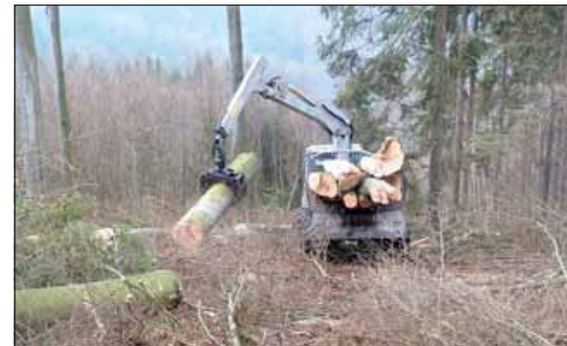
... wyrzynek drewna, dzięki dostosowanej maszynie, każdy rodzaj drewna może być transportowany w ramach zrywki.
