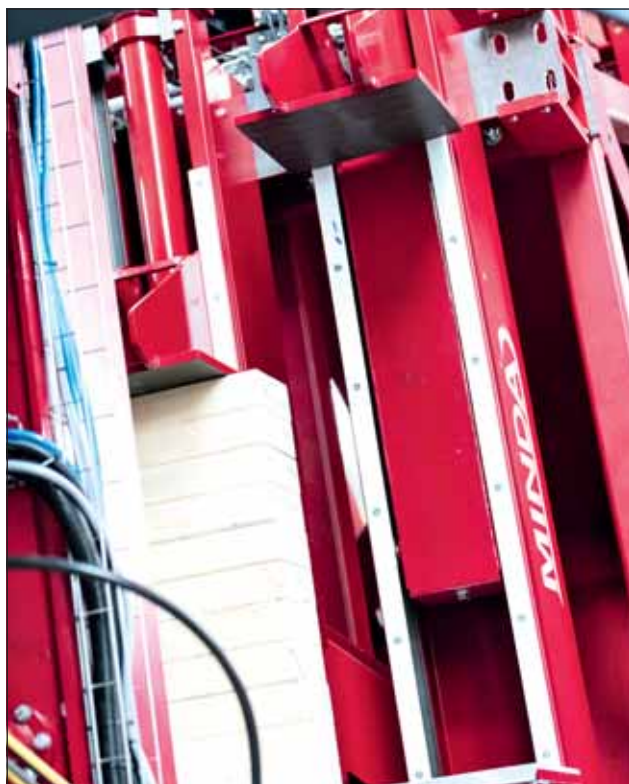
Zmienna linia zerowa na czole prasy umożliwia produkcję o różnych długościach, zapewniając przy tym wysoką jakość końców belki i wysoki uzysk surowca.
