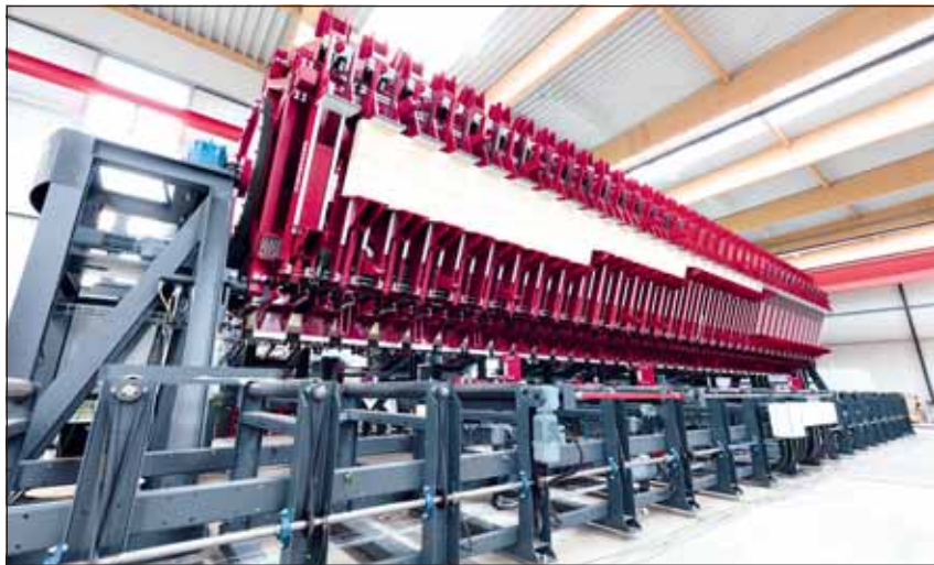
Produkcja na zlecenie w czterech wielkościach w komorze prasowania: prasę rotacyjną wyposażono w celach demonstracyjnych w różnej długości stopniowe wiązary.
