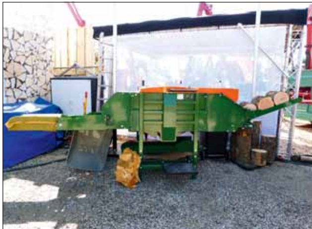
Za pomocą urządzenia „Autosplitt 350“ firmy Posch można wyprodukować i równocześnie zapakować do 100 worków drewna rozpałkowego i drewna lupanego w ciągu godziny (po lewej).
