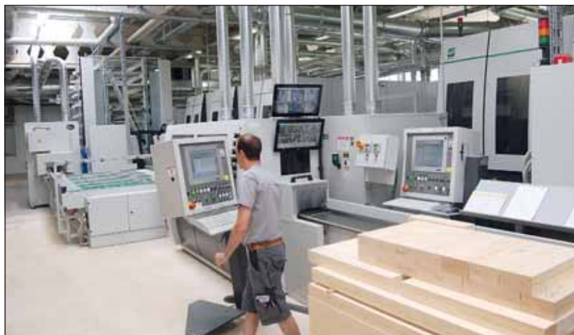
Urządzenie „Conturex“ jest sercem produkcji. W miejscu wylotu, już po kontroli końcowej, urządzenie opuszcza poddane kompleksowej obróbce i gotowe do oklejania elementy.
