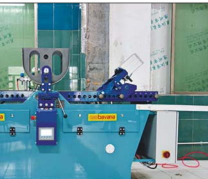
Instalacja parowa do uplastyczniania drewna i (z prawej) giętarka do drewna „Stuzama II” w zakładzie gięcia Cecco Home Furniture (2014) Zdjęcia: GHE Bavaria
