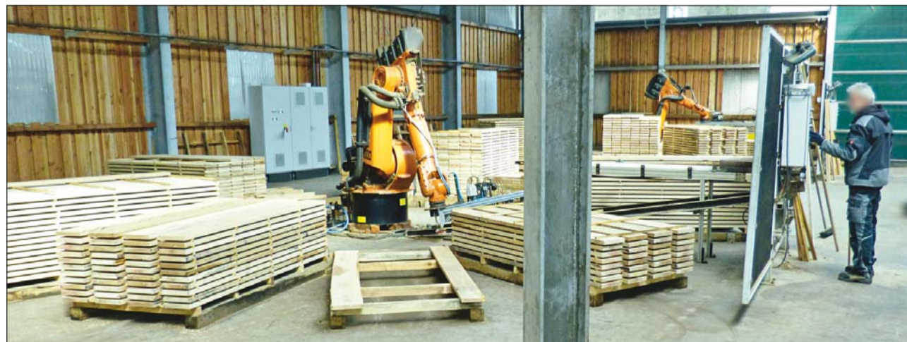
Kółko ukształtowanie strefy roboczej robota przemysłowego z zabezpieczeniem barierami świetlnymi.
