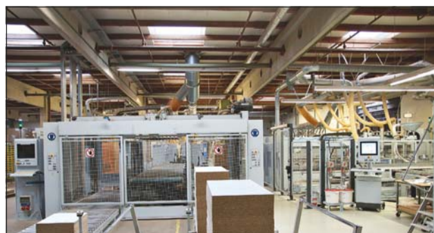
Piła wielkoformatowa „HPP 300“ w firmie Disselkamp zapewnia dokładne cięcie na wymiar.
