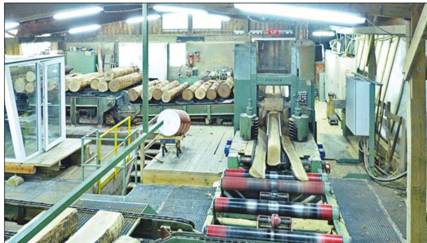
Przebieg hali pilkarskiej w St. Thomas: z lewej sekcja wprowadzania okraglaków do pierwszej operacji cięcia kłody, z przodu po lewej stronie przenośnik poprzeczny do której operacji cięcia kłody.
