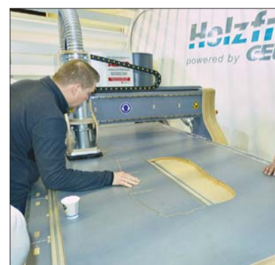
Przedmiot obrabiany jest utrzymywany w pożądanym pozycji przez wióry pozostające w rowku frezowania.
