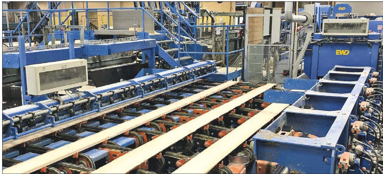
Belka z jednostką do pomiaru poprzecznego linii obrzynania „Optidrive” z ogranicznikiem świetlnym i czujnikami odległości (na zdjęciu po stronie lewej) i wlot pomiaru długości (po stronie prawej). Zdjęcie: Loab
