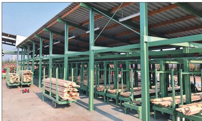
Instalacje tartaku Schilling w Kehrenbergu zostały przekonstruowane i zamontowane w tartaku Michalskiego w Racocie, Polska. Na górnym zdjęciu pilarka Esterer, w środkowej części piła Wurster i Dietz, z lewej w zakładzie Schilling w roku 2015, z prawej u Michalskiego w roku 2017, poniżej po lewej stronie zamontowane boks sortownicze, po prawej te same boks przed demontażem w 2015.
