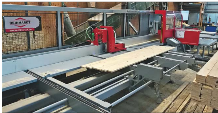
Podczas przesuwu powrotnego popychacz rejestruje długość elementu oraz oznakowuje wady i przesuwa obrabiany element przez stację przetrzynarki.
