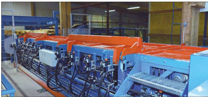
Cały zamknięty system oddzielania od odpadów po skracaniu zrzynów przesuwa się na bok tak, że każda deska jest centrowana na łożu łańcuchowym przenośnika, a odpady po skracaniu zrzynów oddzielane są w pewny sposób. Po stronie lewej, z tyłu widać zasobnik buforowy na materiał główny i tarcicę boczną.
