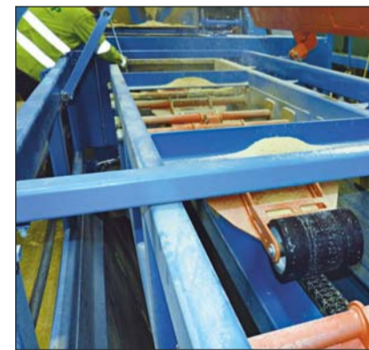
Cały zamknięty system oddzielania od odpadów po skracaniu zrzynów przesuwa się na bok tak, że każda deska jest centrowana na łożu łańcuchowym przenośnika, a odpady po skracaniu zrzynów oddzielane są w pewny sposób. Po stronie lewej, z tyłu widać zasobnik buforowy na materiał główny i tarcicę boczną.
