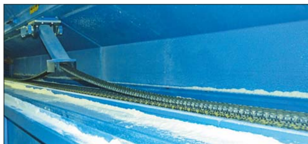
Widok szczegółowy na łańcuch transportujący, który zabezpiecza deskę swoim ciężarem od góry.
