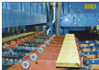
Zębate łańcuchy transportujące i haczenie impulsowe kontrolują transport deski.
