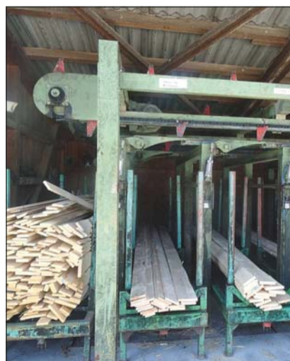
Instalacje tartaku Schilling w Kehrenbergu zostały przekonstruowane i zamontowane w tartaku Michalskiego w Racocie, Polska. Na górnym zdjęciu pilarka Esterer, w środkowej części piła Wurster i Dietz, z lewej w zakładzie Schilling w roku 2015, z prawej u Michalskiego w roku 2017, poniżej po lewej stronie zamontowane boks sortownicze, po prawej te same boks przed demontażem w 2015.
