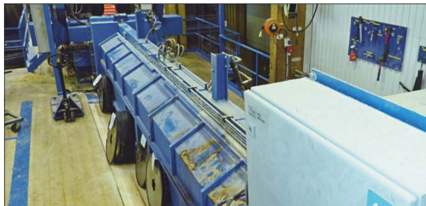
Za stanowiskiem pomiarowym Microtec (na zdjęciu po stronie prawej) 8-metrowy łańcuch transportujący doprowadza deski do jednostki pilarki (po lewej stronie z tyłu).
