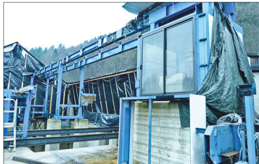
Instalacja podwójnej pilarki taśmowej „Teletwin” obok hali przecierania. W przyszłości będzie mogła zastąpić traki pryzmowania i rozpuszczania pryzmy.
