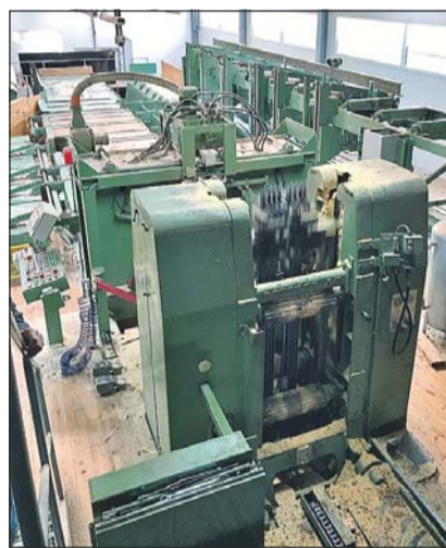
Widok linii przecierania w tartaku Schillinga w zakładzie w Kehrenberg przed demontażem w 2015 r., po lewej stronie z tyłu okrawarka boków, z prawej strony podnośnik i przenośnik rolkowy transportujący materiał do pily.
