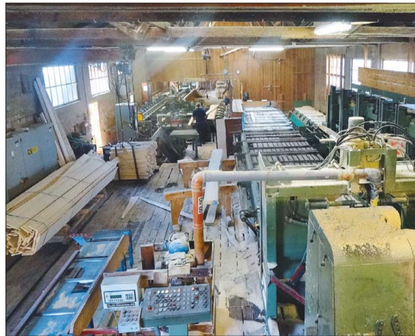
Widok linii przecierania w tartaku Schillinga w zakładzie w Kehrenberg przed demontażem w 2015 r., po lewej stronie z tyłu okrawarka boków, z prawej strony podnośnik i przenośnik rolkowy transportujący materiał do pily.
