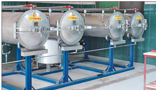
Instalacja parowa do uplastyczniania drewna i (z prawej) giętarka do drewna „Stuzama II” w zakładzie gięcia Cecco Home Furniture (2014) Zdjęcia: GHE Bavaria
