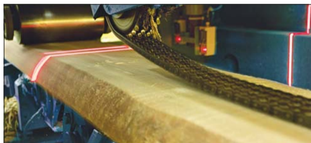
Skanner offlisu Micritec dokonuje pomiaru deski podczas przepływu wzdłużnego. Zdjęcie: Loab
