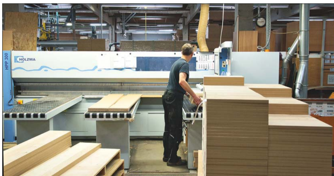
Piła wielkoformatowa „HPP 300“ w firmie Disselkamp zapewnia dokładne cięcie na wymiar.
