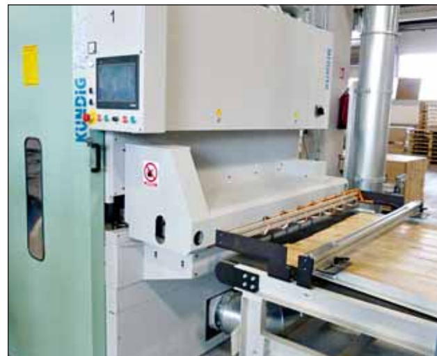
Linia do obróbki powierzchni o długości 120 m z systemami malowania SCM (po lewej) i szlifierką Kündig (po prawej) została zaprojektowana dla wydajności dziennej 4500 m 2 .
