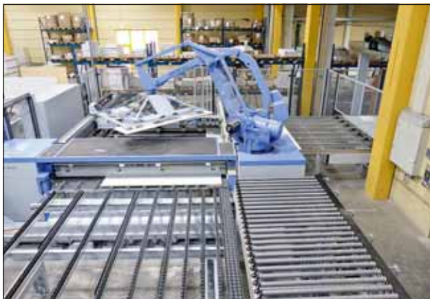
Dzięki wydajnej optymalizacji (pozostawione szare obszary) podczas równoległej realizacji kilku zleceń, w obszarze cięcia, który jest zaopatrywany przez robota, może być wykorzystana maksymalna ilość płyt.
