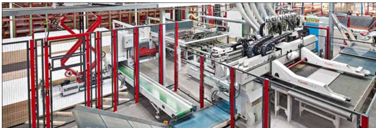
Widok ogólny na linię produkcyjną – podawanie z suwnicą próżniową i magazynowanie, z tyłu po środku umieszczane są płyty, następnie uruchamiana jest piła poprzeczna i frezarka – na pierwszym planie. Przenośnik rolkowy prowadzi do jeża w tle u góry, po prawej. Zdjęcia: Carsten Krüger
