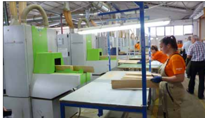
Pilarki ramowe do przecierania cienkich desek typu „DSG Sonic”, firmy Wintersteiger charakteryzują się roczną wydajnością na poziomie 550 000 m 2 przy pracy w systemie dwuzmianowym.
