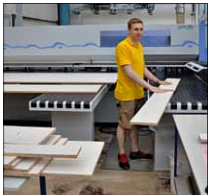
Pila do cięcia płyt firmy Homag „HPP 300 profileline“ (dziś: „Sawteq B-300“) pracuje w pełni automatycznie i wymaga tylko jednego operatora do obsługi.
