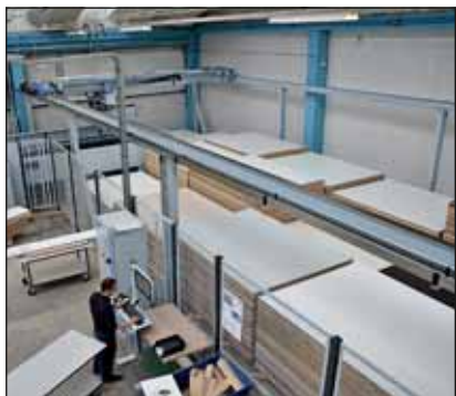
Pila jest podłączana bezpośrednio do systemu magazynowania „TLF 211“ (dziś: „Storeteq S-200“) i jest zasilana materiałem za pomocą przenośnika poprzecznego ssącego „ST 61“.
