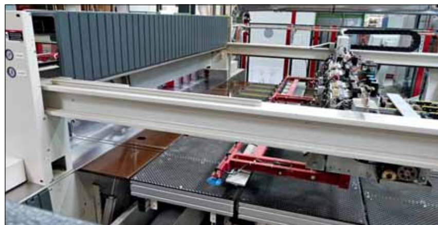
W pilarkę wzdłużnej z belką dociskową, po pierwszym cięciu wzdłużnym następuje wstępne cięcie poprzeczne odpadów i rzeczywiste cięcie na pasma.
