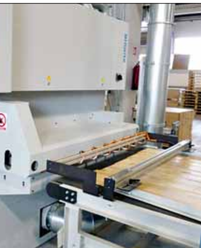
Linia do obróbki powierzchni o długości 120 m z systemami malowania SCM (po lewej) i szlifierką Kündig (po prawej) została zaprojektowana dla wydajności dziennej 4500 m 2 .
