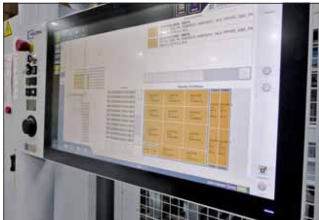
Dzięki wydajnej optymalizacji (pozostawione szare obszary) podczas równoległej realizacji kilku zleceń, w obszarze cięcia, który jest zaopatrywany przez robota, może być wykorzystana maksymalna ilość płyt.
