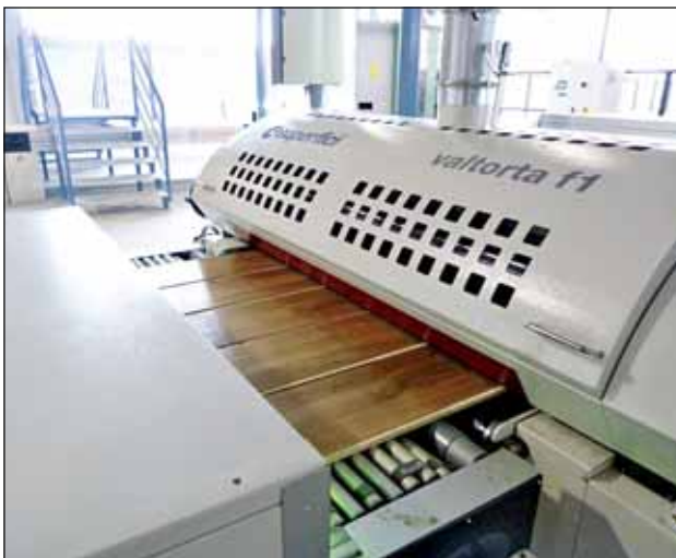
Linia do obróbki powierzchni o długości 120 m z systemami malowania SCM (po lewej) i szlifierką Kündig (po prawej) została zaprojektowana dla wydajności dziennej 4500 m 2 .
