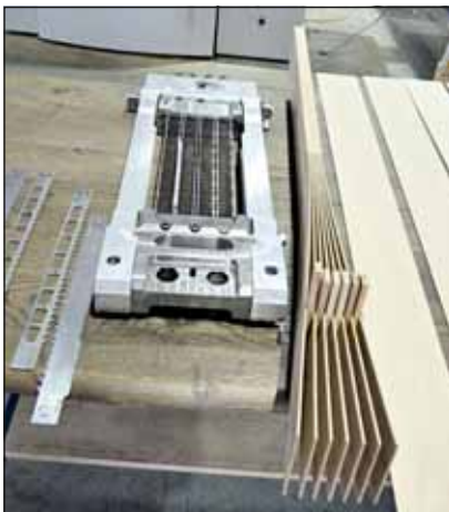
... natomiast dłuższe formaty desek podłogowych z wpustem za pomocą pilarki ramowej do przecierania cienkich desek, firmy Wintersteiger.
