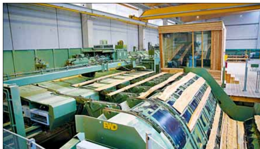
EWD wykonała w nowo wybudowanym tartaku system do obrzynania „Optimes-BKO”, umożliwiając maksymalne uzyskanie produktu gotowego.
