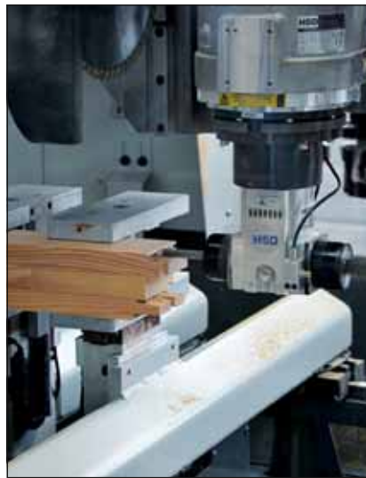
Centrum obróbcze podczas eksploatacji: frezowany jest akurat czop dłutowany, do którego Leopold przywiązuje dużą wagę.
