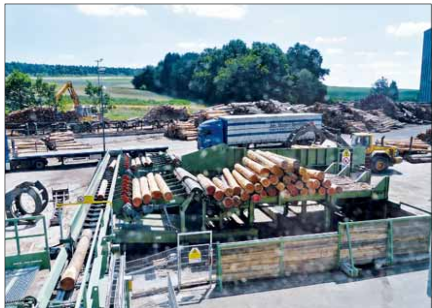
Podajnik kłód z dwoma pokładami, drugi niestety zasłonięty. Stąd kłody trafiają do obrotu, a następnie na urządzenia tnące.
