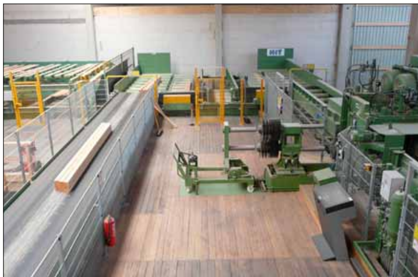
Przenośnik taśmowy transportuje materiał główny do przenośnika poprzecznego, który następnie przekazuje go do sortowni. Po prawej zespół urządzeń docinających (chwilowo niewykorzystywany), pośrodku wymiennik narzędzi obsługujący pilę tarczową do docinania materiału.
