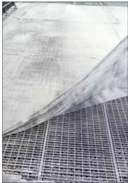
Specjalna włóknina na podłodze kabiny, która jest codziennie odnawiana, odciąża znajdujący się pod spodem filtr kartonowy, co zmniejsza czas przygotowania i koszty.
