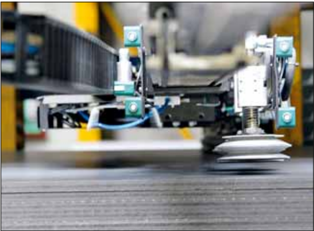
Próżniowy system do podnoszenia materiałów, w tym ciężkich płyt o wymiarach do 6 m i ciężarze do 350 kg
