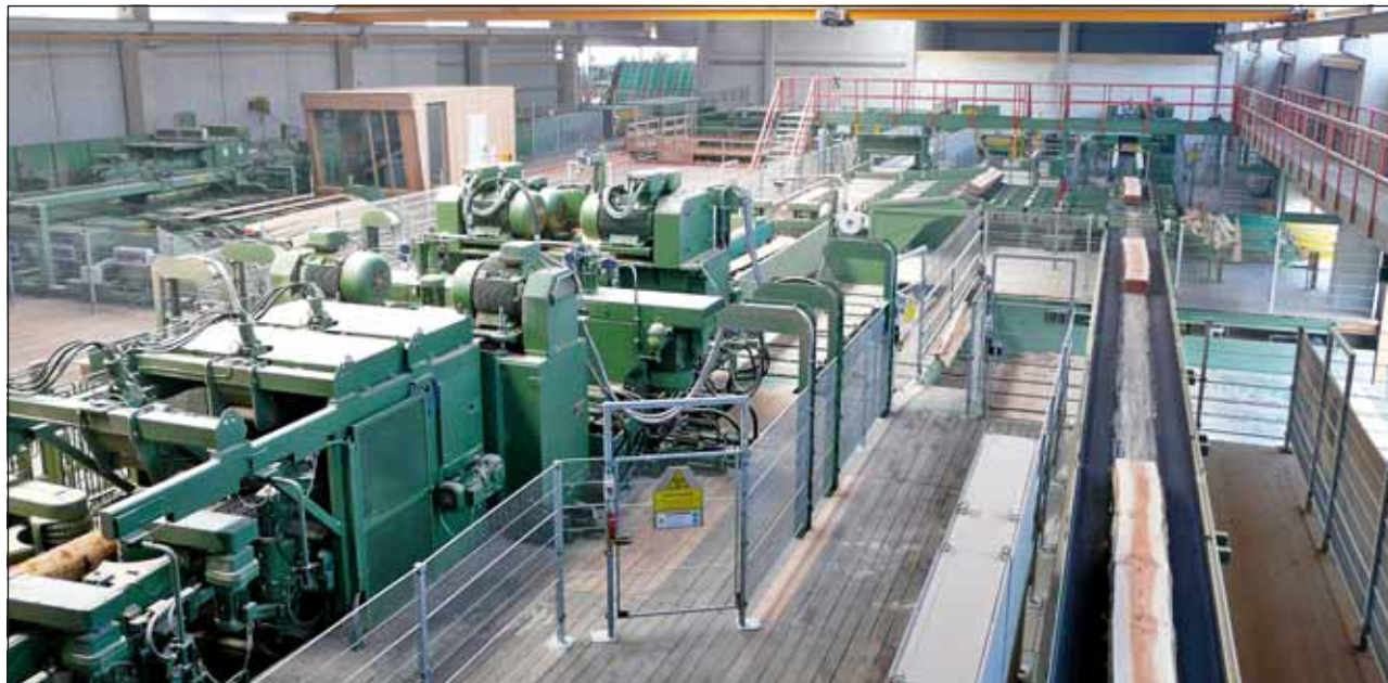
Widok na halę tartaczną z linią przecierającą kłody daglezji: z przodu po lewej pierwszy zespół maszyn, po prawej modelowy przenośnik obiegowy. Na dalszym planie po lewej widoczna obrzynarka, za nią przejście do sortowni tarcicy.
