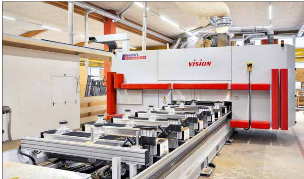
Największy model „Vision II Sprint” posiada automatyczny stół z płytą nośną i mechanizm zmieniający do 40 narzędzi.
