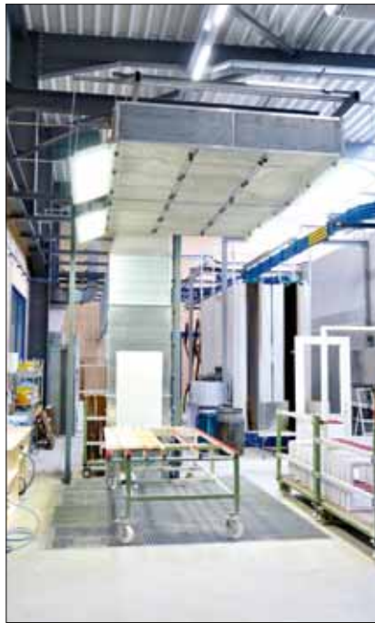
Szlifowanie pomiedzne nie dokonuje się na wieszaku, lecz na stole szlifowania z wyciągiem podłogi.
