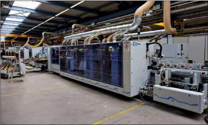
Prezentacja w Schopfloch: przednia część linii produkcyjnej do wytwarzania wręgów wraz z frezarką referencyjną do obrzeży i maszyną do obrzeży z wpustem „KFL 623“ aż po magazynek obrzeży
