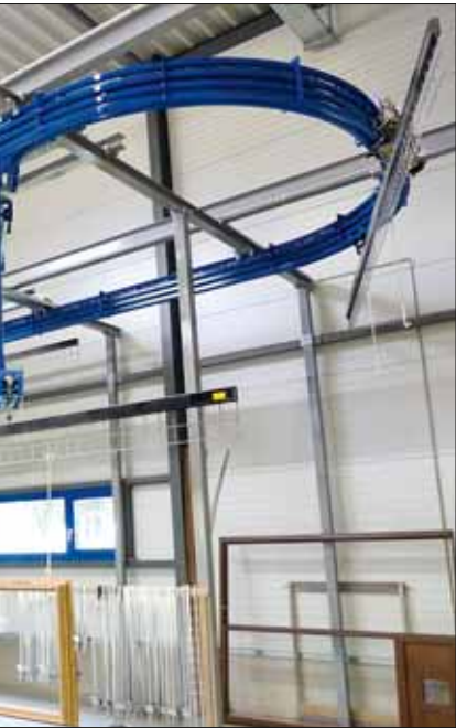
Przekazanie do obszaru nakładania powłoki końcowej odbywa się na kolejnym stanowisku opuszczanym.
