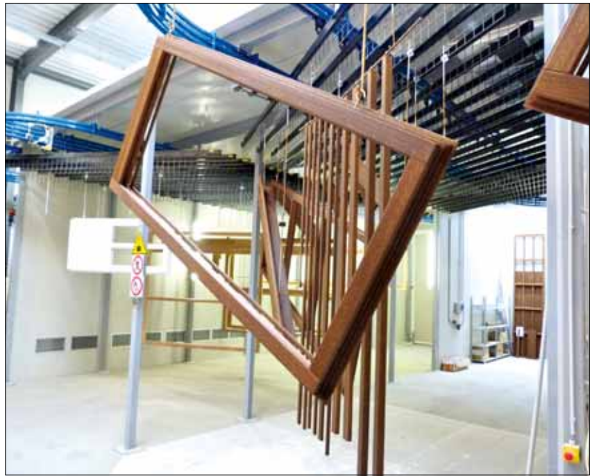
Po ocieknięciu element (brązowy) przesuwają się w kierunku suszenia. Po drugiej stronie tunelu przemieszczają się w przeciwnym kierunku elementy pokryte ostatnią warstwą lakieru (białe) przez suszarkę, w tle można zobaczyć otwartą kabinę lakierniczą.
