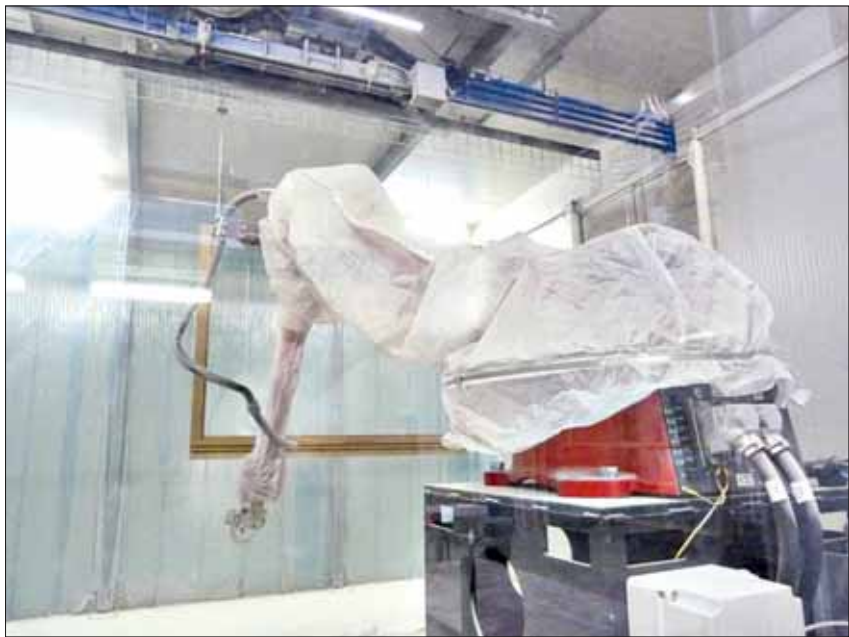
Robot pracuje zgodnie z wygenerowanym automatycznie programem lakierowania. W kabinie można byłoby w razie potrzeby zainstalować drugiego robota, aby możliwe było równoczesne natryskiwanie strony przedniej i tylnej.
