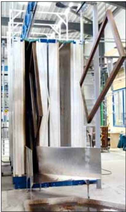
Skrzydło opuszcza jeden z dwóch tuneli z dyszami, jest obracane i ocieka w przeznaczony z tego strefie.
