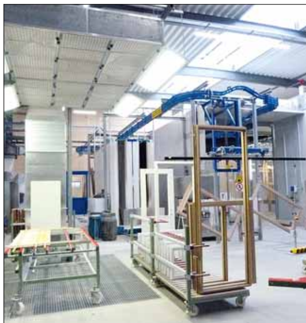
Całkiem nowy jest natomiast dział lakierniczy (za wyjątkiem jednego stanowiska ręcznego natrysku), obszar impregnowania (od lewej); miejsca szlifowania szlifu pośredniego, tunel z dyszami, suszarka kondensacyjna, a z przodu stanowisko opuszczane.
