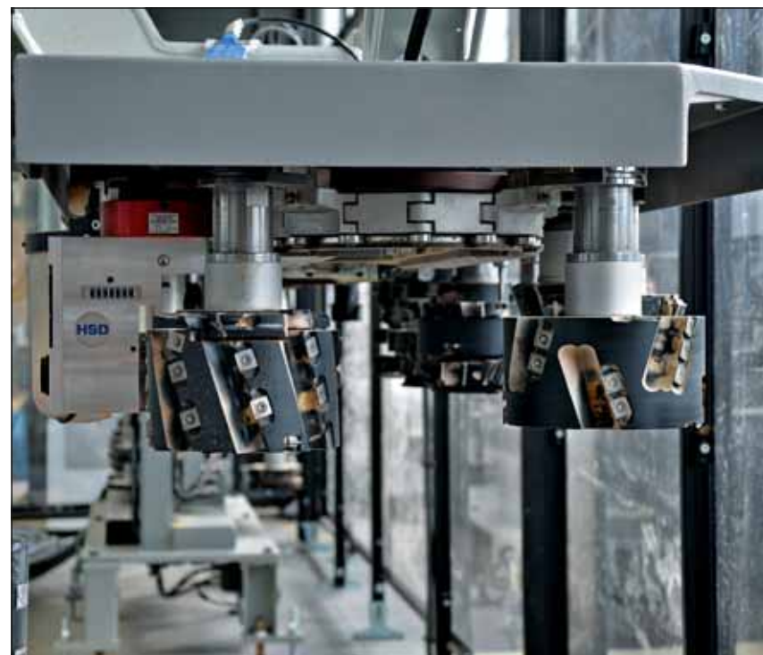
Widok na narzędzia Leitz, linia „Q-Premium“, które dostępne są w poruszającym się magazynku wrzeczona 30 kW
