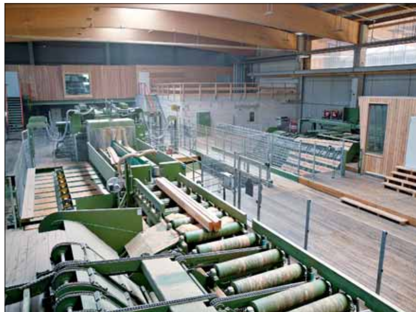
Pierwszy zespół maszyn w obrębie linii okrawarkowo-pilarkowej z systemem oddzielania bocznych desek. Po prawej zespół korekcyjny obrzynarki oraz kabina operatora obrzynarki
