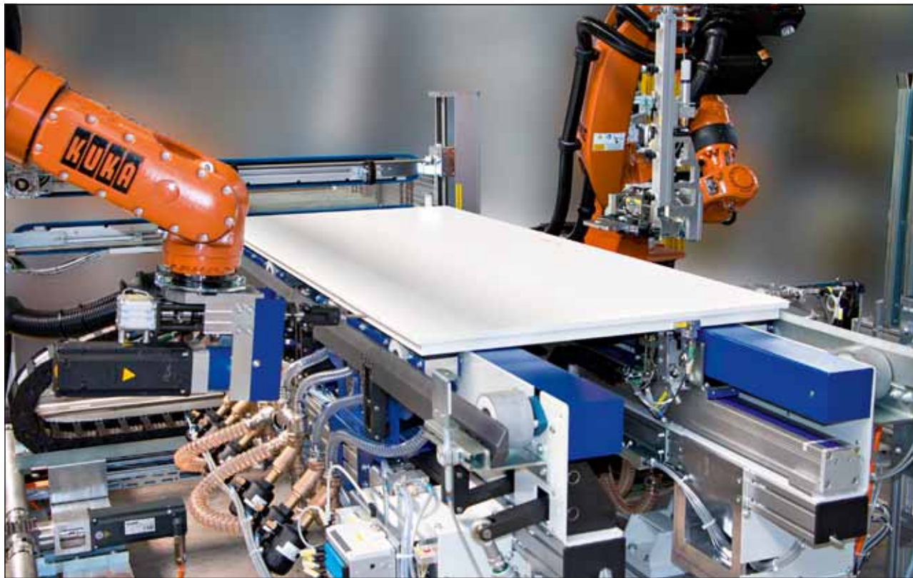
Widok ogólny na stanowisko montażowe o dużym potencjale w zakresie dopasowania do potrzeb, wyposażone z jednego robota do skrynek do zamka skrzynkowego (z tyłu) i drugiego do montażu taśm (z przodu)
