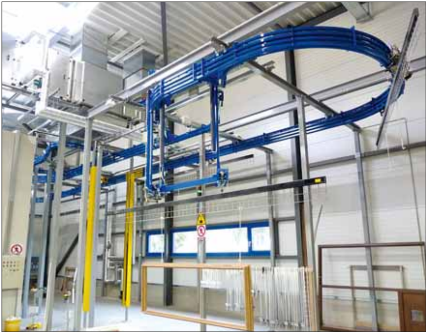
Przekazanie do obszaru nakładania powłoki końcowej odbywa się na kolejnym stanowisku opuszczanym.
