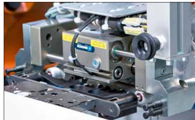
Automatyczne umieszczanie skrzynki do zamka skrzynkowego w wyfrezowanej przestrzeni
